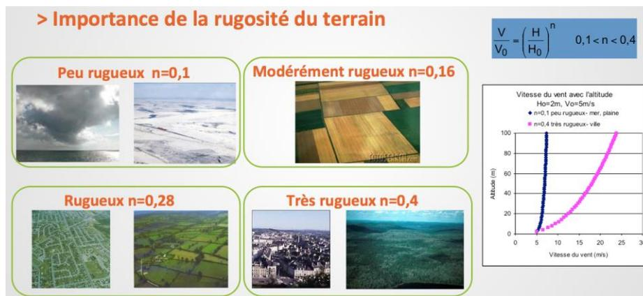
➤ Donc il existe une loi simple qui est une loi en puissance qui donne la vitesse  $V$  à l'altitude  $H$ , à condition de connaître la vitesse  $V_0$  à l'altitude  $H_0$ , moyennant l'indice  $n$  qui est l'indice de rugosité qui dépend de l'état du sol.
