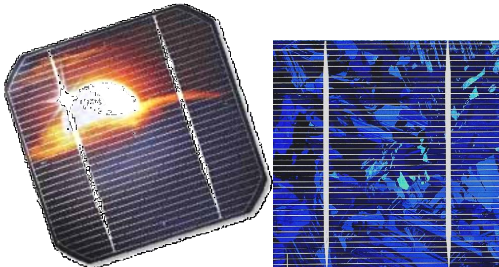
Figure 49 : Cellules au c-Si, à gauche monocristallin, à droite multi-cristallin.
