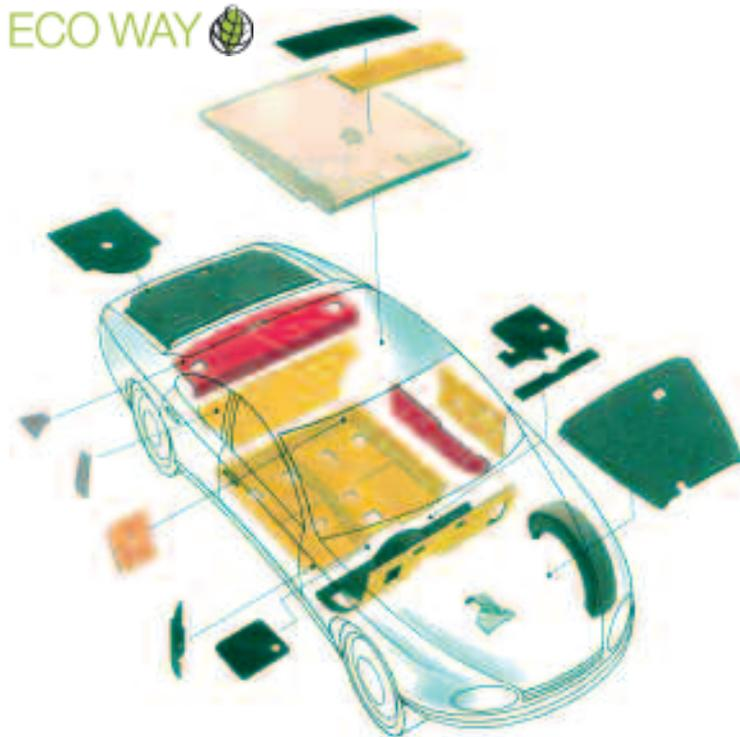
Pièces et équipements fabriqués par RIETER pour les véhicules
