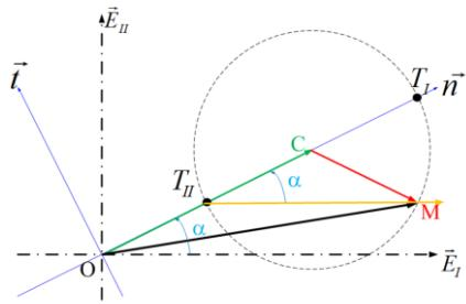
A partir de cette construction, on constate que lorsque l'on trace une droite joignant le point à valeur propre minimale  $T_{II}$  au point courant du cercle M associé à notre vecteur normal  $n$ , on obtient un angle alpha avec cette normale. Cette droite est parallèle à la direction du vecteur propre maximal  $E_I$ .
