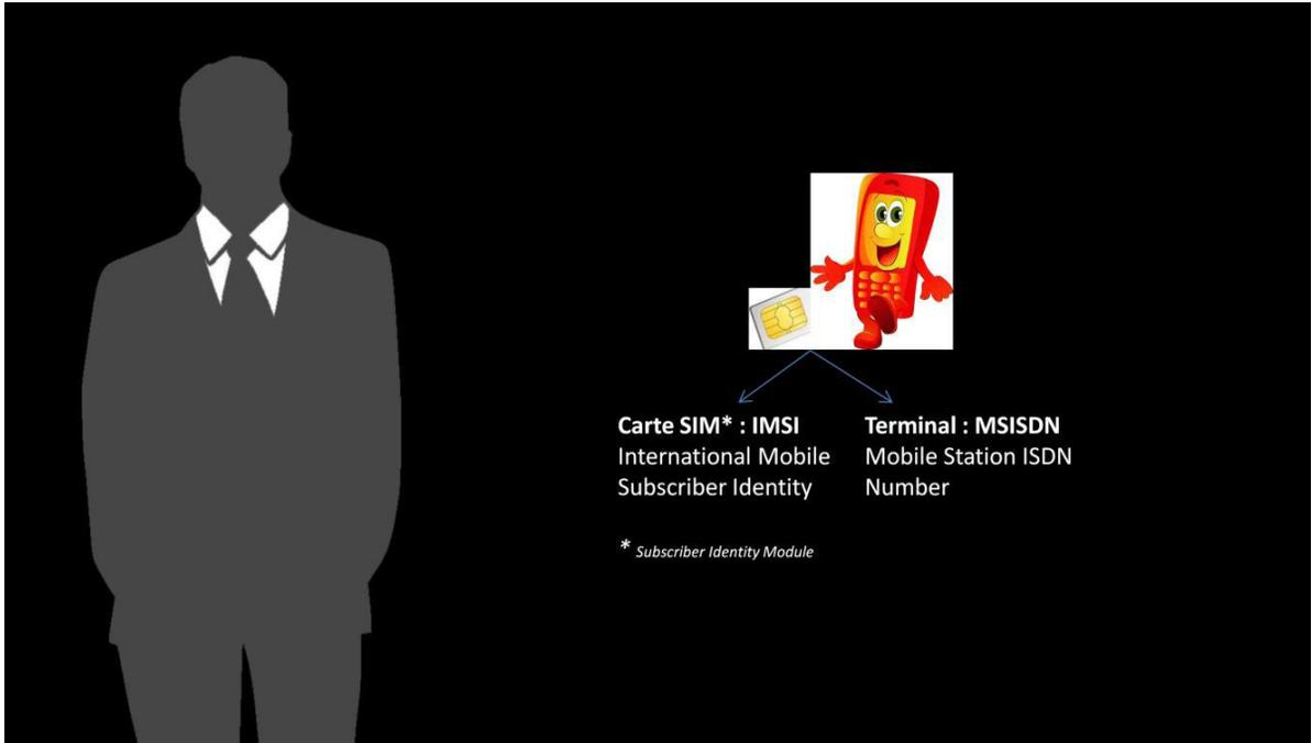
Côté terminal, des données sont également mémorisées sur la carte SIM (Subscriber Identity Module) insérée dans chaque terminal mobile. Un certain nombre d'identifiants permettront à l'utilisateur d'être reconnu par son opérateur, et d'utiliser les services auxquels il a souscrit.
