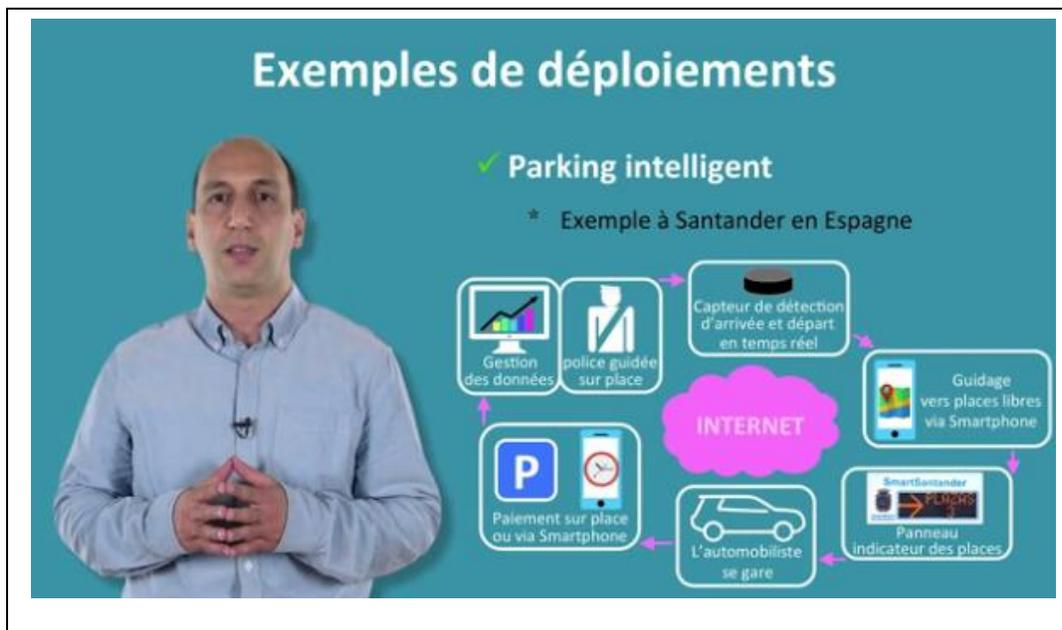
La ville de Santander, en Espagne, a mis en place un réseau de capteurs communicants permettant de déployer un système global de supervision et d'information des places de parking.
