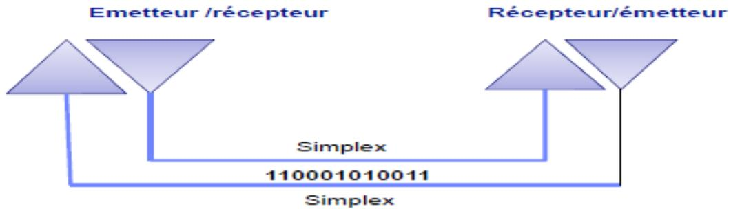
La voie que nous avons dessinée au début est unidirectionnelle. On dit aussi **simplex**. Par exemple : un canal radio ou un canal satellite.
