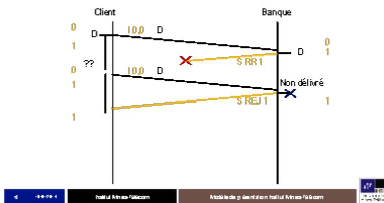
Le compteur VR présent chez le récepteur, et dont nous avons déjà parlé, permet de régler le problème des duplicatas. Ainsi, si l'émetteur réémet une trame déjà reçue par le récepteur, le récepteur se rend compte, en comparant le numéro de la trame NS à son compteur VR, que ce n'est pas la trame qu'il attend. Dans cette situation, le récepteur envoie une trame d'indication d'erreur de type REJ dans laquelle le champ NR prend la valeur de VR ; c'est-à-
