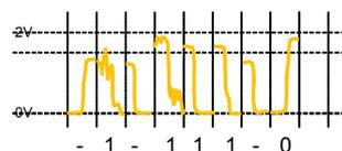
Afin de distinguer des successions de valeurs similaires, une solution est d'émettre un signal alternatif codant à la fois la valeur binaire et l'horloge. Celui-ci permet au récepteur de définir des périodes de mesure. Le codage Manchester est un exemple de signal de ce type,
