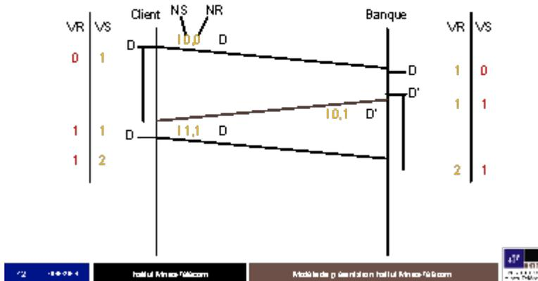
La possibilité de transmettre des trames d'information dans les deux sens est utilisée par HDLC pour une autre amélioration appelée « piggy backing ». L'idée est d'utiliser les trames d'information afin de réaliser les acquittements sans utiliser de trame de contrôle. Ce mécanisme est donc utilisé par le récepteur lorsque celui-ci doit envoyer un acquittement à l'émetteur et doit envoyer à peu près au même moment une trame d'information à celui-ci.
