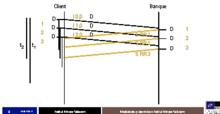
Dans le cas d'une mise en pipeline, les trames d'information peuvent être émises sans attendre ; ce qui réduit le temps total de transmission<sup>1</sup> à t2, t2 plus court que t1. L'existence du mode pipeline dans HDLC implique la possibilité, pour plusieurs minuteurs, d'être enclenchés simultanément, chacun étant attaché à l'émission d'une trame d'information.
