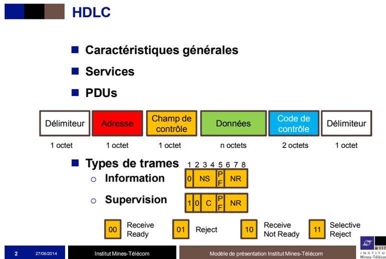
Le protocole HDLC, pour « High-Level Data Link Control », est un protocole de niveau « liaison de données » développé dans les années 70. D'abord utilisé très largement dans les réseaux étendus tels que X25, il a inspiré par la suite de nombreux autres protocoles. Le protocole HDLC peut fonctionner dans plusieurs modes. Celui qui nous intéresse aujourd'hui étant le mode appelé asynchrone équilibré. Ce mode permet la communication entre deux systèmes.
